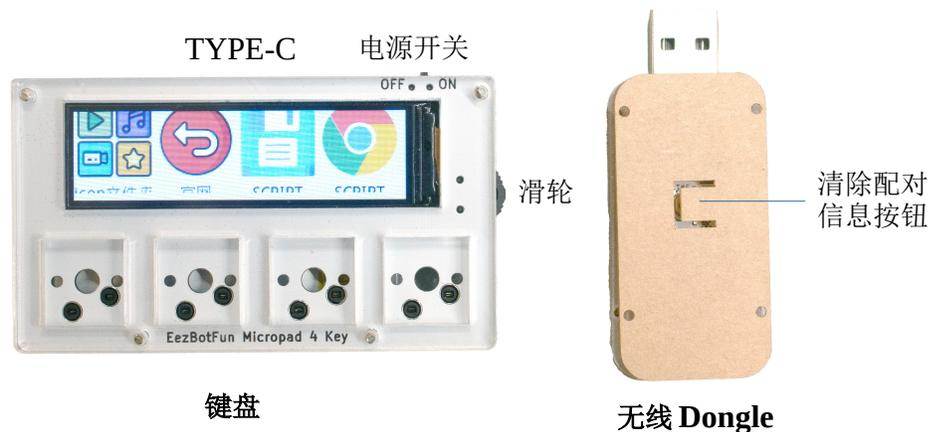
如上图所示，键盘顶部依次为 Type-C USB 数据线插口和电源开关（往右为开），右边为切换布局滚轮（上下滑动可以切换布局，按下则切换到 USB 副屏），下方为 4 个支持热插拔（Hot-swap）的凯华轴座。
